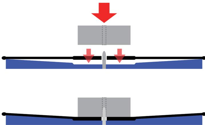
お手持ちのスタビライザーの重量を加える事で、レコードとターンテーブルシートが一体化します。これによりレコード盤がカンチレバーに対して余計な振動を与えないため、ロスとなるニードルトークも減少し音溝に刻まれた情報を最大限に引き出すことができます。
